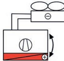
Im Kühlbetrieb wird das Kältemittel im Wärmetauscher der Maschine im Haus verdampft, wodurch dem Wasserkreislauf Energie entzogen wird, es kühlt ab. Das Kältemittel wird über die Kompressoren verdichtet und in den Außenbereich transportiert und durch das Rückkühlwerk, welches nun als Kondensator funktioniert, wieder in flüssige Form gebracht, sodass die Energie an die Außenluft abgegeben wird.
