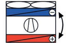
Im Kühlbetrieb wird im Wasserwärmetauscher der Maschine das Kältemittel verdampft. Dieser Vorgang entzieht dem Wasserkreis Energie, sodass dieser abkühlt. Die im Kältemittel aufgenommene Energie wird an die angesaugte Luft abgegeben. Die Luft erwärmt sich im Luftwärmetauscher und das Kältemittel kondensiert.
