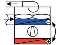
Die Luft erwärmt sich im Luftwärmetauscher und das Kältemittel kondensiert. Die Geräte sind kompakt und müssen nur an passende Zu- und Abluftkanäle angeschlossen werden.
