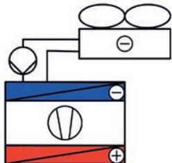
**3** *Luft-Wasser Wärmepumpen gesplittet (getrennte Aufstellung)*
